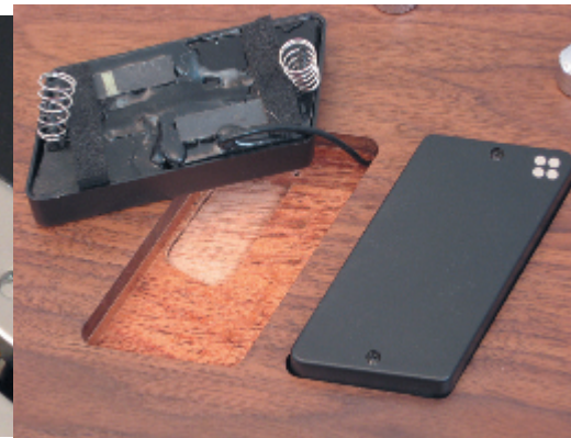
In den Salino-Kappen steckt ein Splitcoil mit Preci-Spulengeometrie.
